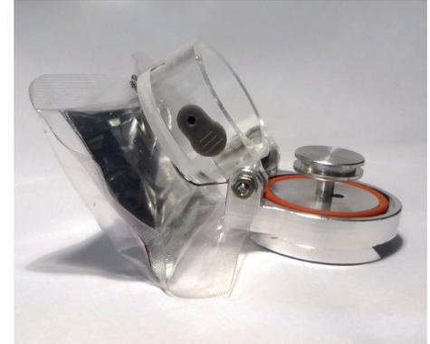
drückt, dass die Dose luftdicht abgeschlossen ist. Ein außen angebrachter, mit Flüssigkeit gefüllter Blähkörper ist außerhalb des Vakuums entspannt. Bringt man die Dose ins Vakuum, beispielsweise in die Messkammer eines Analysegeräts, so fängt die Flüssigkeit im Blähkörper an zu siedeln. Dabei expandiert der Blähkörper und zieht so den Deckel auf. Beim Aufheben des Vakuums entspannt sich der Blähkörper und der Deckel der Vakuumdose wird von der Spannfeder wieder dicht geschlossen.
